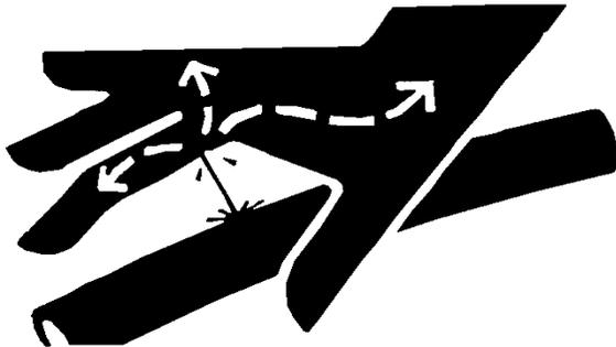
Mantenga el cuerpo y las manos alejados de los orificios de fugas o las boquillas que expulsan fluido hidráulico a alta presión. Use papel o cartón, no las manos, para buscar fugas. El fluido hidráulico que escapa a presión puede tener suficiente fuerza para penetrar la piel y causar lesiones graves. Si el fluido penetra en la piel, un médico competente en este tipo de lesiones debe retirarlo por medios quirúrgicos en un lapso de pocas horas; de otro modo, se podría originar una gangrena.
