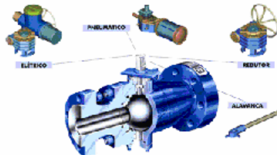
FIGURA 26 - VÁLVULA DE ESFERA COM POSSIBILIDADE DE OPERAÇÃO MANUAL E MOTORIZADA.
