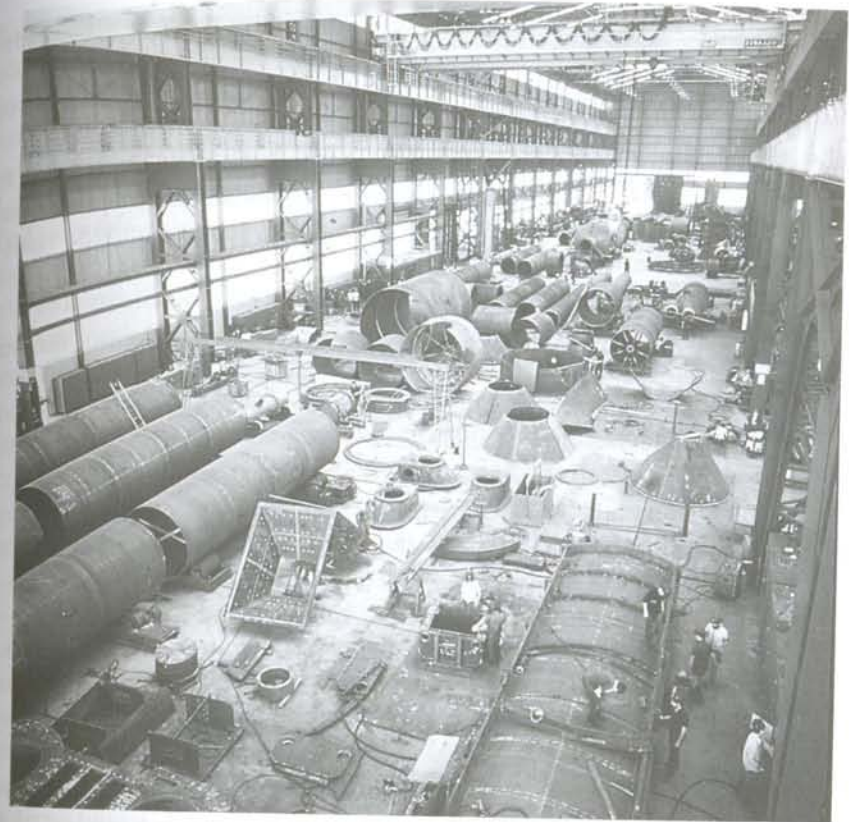
Fig. 12.1 Grande galpão de oficina de fabricação de vasos de pressão. Cortesia de CONFAB Industrial S.A.
