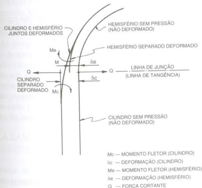
Fig. 5.2 Momentos fletores e deformações na ligação cilindro-tampo hemisférico.
