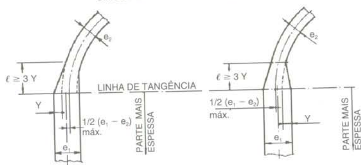
b) LIGAÇÃO ENTRE CILINDROS E TAMPOS
