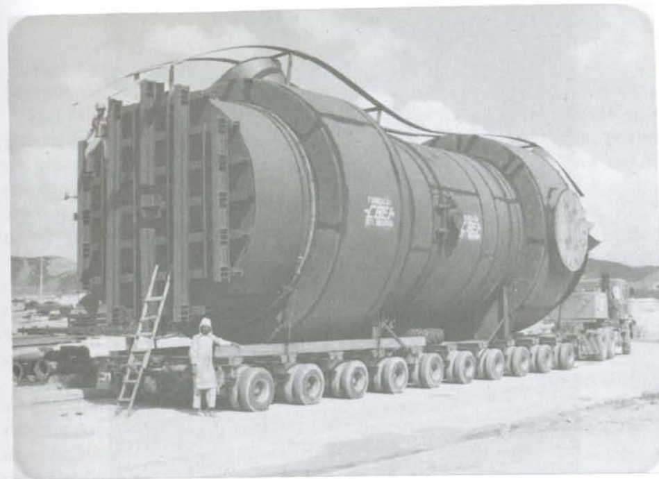
Fig. 1.1 Grande vaso de pressão pronto para o transporte: trocador de calor para ácido sulfúrico, para a Caraíba Metais. A foto é cortesia do Eng. Carlos Dittmar Filho. Peso: cerca de 200t.
