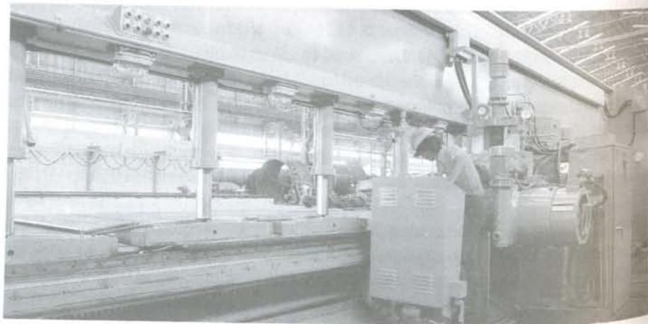
Fig. 12.3 Plaina-fresadora para a preparação de bordas de chapas. Cortesia de CONFAB Industrial S.A.
