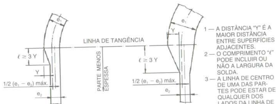
c) LIGAÇÃO ENTRE CILINDROS E TAMPOS
