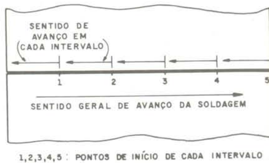
Fig. 12.10 Sequência de soldagem por "passo peregrino".
